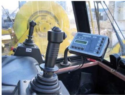
Рис.3. Рабочее место крановщика крана ДЭК-361
