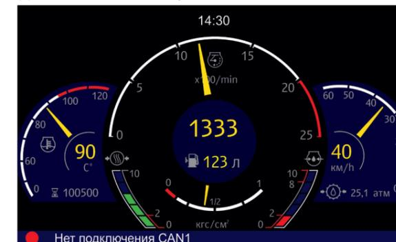
Отображаемые параметры: температура охлаждающей жидкости, частота вращения двигателя, скорость движения машины.
