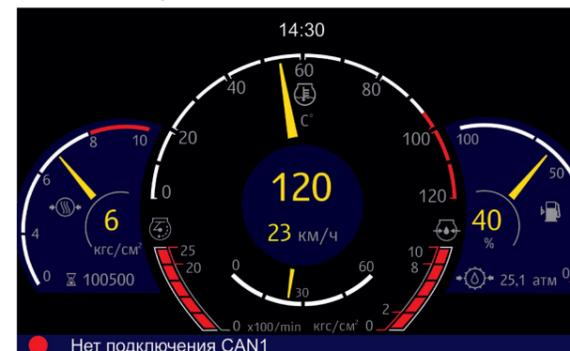
Отображаемые параметры: давление в пневмосистеме, температура охлаждающей жидкости, уровень топлива.
